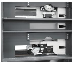
Sólida guía del carro de prensado con fácil acceso para mantenimiento
