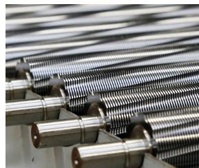
Los cilindros de corte de acero endurecido por inducción garantizan una larga vida útil.
