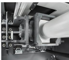
Soporte del cilindro de la prensa con cardán - Hay un menor desgaste del cilindro de la prensa, y la guía de la plancha de prensado
