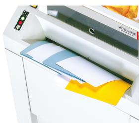
Una célula fotoeléctrica inicia el equipo automáticamente y lo detiene tras destruir todo el material.
