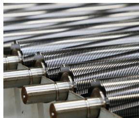
Los cilindros de corte de acero endurecido por inducción con garantía de por vida son resistentes a las grapas y los clips, y garantizan una larga vida útil.
