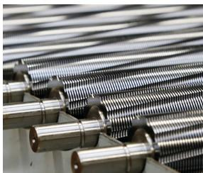
Los cilindros de corte de acero endurecido por inducción son resistentes a las grapas y los clips, y garantizan una larga vida útil.
