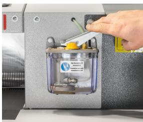
Dispositivo de lubricación manual integrado para una potencia de corte y una calidad elevadas y constantes.
