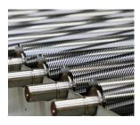
Los cilindros de corte de acero endurecido por inducción son resistentes a las grapas y los clips, y garantizan una larga vida útil.
