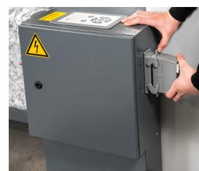
La combinación se puede poner en marcha con mucha facilidad mediante Plug-and-Play. Por lo tanto, la destructora con la cinta transportadora se puede combinar con la prensa en cualquier...
