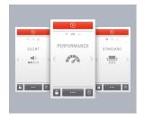
El sistema de accionamiento y selección IntelligentDrive ofrece tres modos de funcionamiento:para una destrucción de datos silencioso,estándar o con un rendimiento hasta un 40% superior
