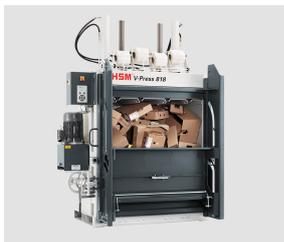
Para llenar la prensa se empuja la mitad superior de las puertas hacia abajo y se abre automáticamente tras el proceso de prensado
