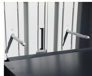
Cilindros de retención especiales optimizan la compactación, evitando la expansión del material prensado en la zona de entrada
