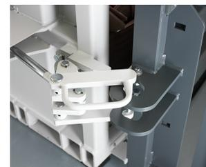
Cierre hidráulico - Cómoda apertura y cierre, no es necesario realizar ningún esfuerzo manual
