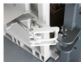
Cierre hidráulico - Cómoda apertura y cierre, no es necesario realizar ningún esfuerzo manual
