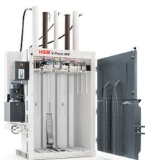
Perfiles especiales en la puerta de descarga de las balas, así como en la trampilla de llenado y en la plancha de prensado forman una cavidad en la bala
