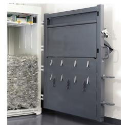
La duplicación del número de garras de retención optimiza la compresión del material de prensado y reduce el número de cargas
