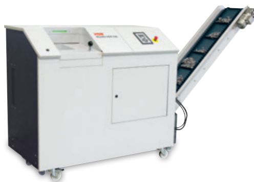
HSM StoreEx HDS 230 mit Auslaufförderband
