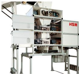
Schredder-System mit drei Zerkleinerungsstufen.
