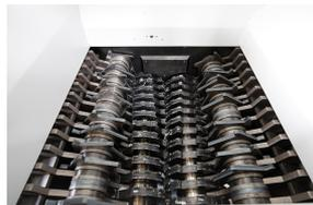
1. Stufe Vorzerkleinerung als Vierwellen-System, bestehend aus zwei Einzugswellen und zwei Schneidwellen.
