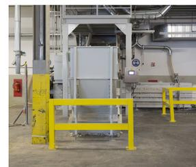
Schnelle Taktzeiten, Einfüllöffnung (800 mm Länge)
