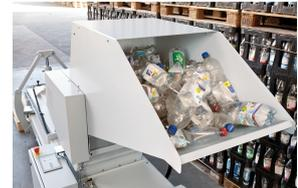
Effektives System zur Verdichtung von PET-Flaschen auf ca. 90 % des ursprünglichen Volumens zu kompakten Rohstoffballen – inklusive Pfandentwertung
