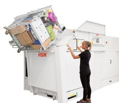
Komfortable und besonders schnelle Befüllung durch automatische hydraulische Hub-Kipp-Vorrichtung
