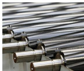
Die induktionsgehärteten Vollstahl-Schneidwellen garantieren Langlebigkeit.
