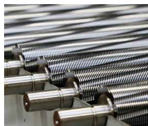
Die induktionsgehärteten Vollstahl-Schneidwellen garantieren Langlebigkeit.
