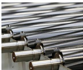
Die induktionsgehärteten Vollstahl-Schneidwellen garantieren Langlebigkeit.
