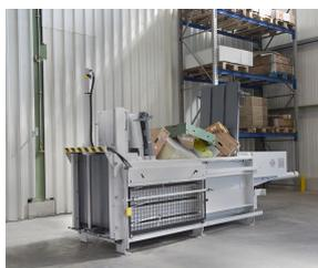
Hydraulische Gegenplatte für die Ballenentnahme sorgt für höchsten Bedienkomfort und höchste Bediener-sicherheit
