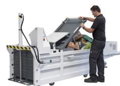
Geringe Bauhöhe, große Einfüllöffnung, auch für sperrige Materialien geeignet
