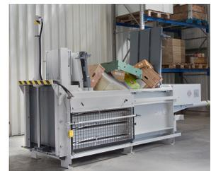
Hydraulische Gegenplatte für die Ballenentnahme sorgt für höchsten Bedienkomfort und höchste Bediener-sicherheit
