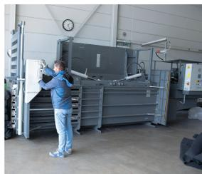
Absicherung des Gefahrenbereiches durch Infrarot-Lichtvorhänge gewährleistet höchsten Schutz für den Bediener
