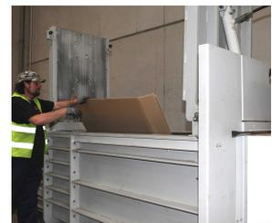
Mit der großen Einfüllöffnung lässt sie sich einfach und bequem beschicken
