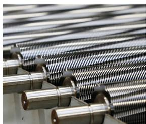
Die induktionsgehärteten Vollstahl-Schneidwellen mit lebenslanger Garantie sind unempfindlich gegen Heft- und Büroklammern und garantieren Langlebigkeit.
