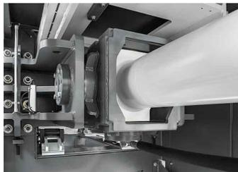
Vollkardanische Presszylinderaufhängung - Reduzierter Verschleiß des Presszylinders und der Pressplattenführungen
