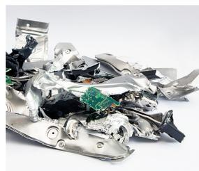
Eine herkömmliche 3,5 Zoll Festplatte wird in mindestens drei Teile zerteilt („H-3 security cut“). Das Sicherheitsniveau ist damit um ein Vielfaches höher als bei konventionellen Verfahren.
