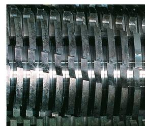
Die induktionsgehärteten Vollstahl-Schneidwellen sind unempfindlich und garantieren Langlebigkeit.
