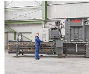
Mit großer Einfüllöffnung für optimierte Beschickungsmöglichkeiten (1600 mm Länge)
