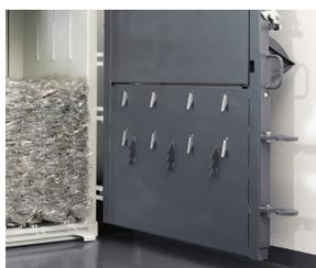
Spezielle Rückhaltekrallen optimieren die Verdichtung des Pressmaterials.
