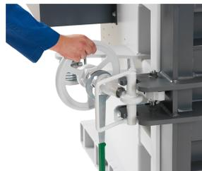
Handrad-Türverschluss - Leicht zu handhaben dank gegenläufigem Gewinde für schnelles Öffnen und Schließen
