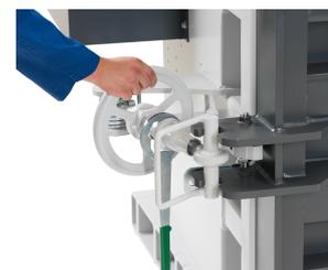
Handrad-Türverschluss - Leicht zu handhaben dank gegenläufigem Gewinde für schnelles Öffnen und Schließen
