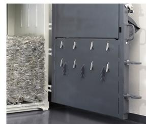
Doppelte Anzahl Rückhaltekrallen optimieren die Verdichtung des Pressmaterials und reduzieren die Zahl der Befüllvorgänge
