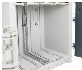
Besonders robuster mechanischer Kettenauswerfer
