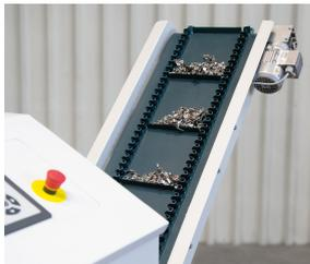
Das geschredderte Material wird über ein Förderband ausgegeben und kann in allen gängigen separaten Behältern gesammelt werden.
