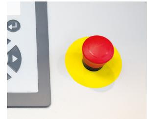
Bei Betätigung des Not-Aus-Schalters wird das Gerät sofort gestoppt.
