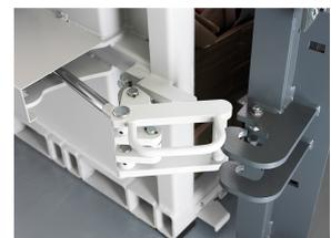
Hydraulischer Türverschluss - Komfortables Öffnen und Schließen, kein manueller Kraftaufwand notwendig
