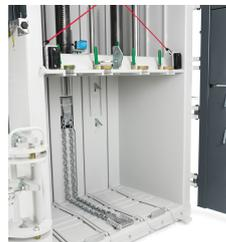
Besonders robuster mechanischer Kettenauswerfer
