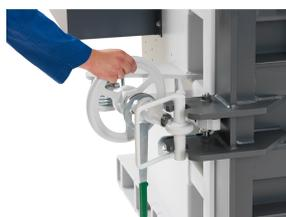
Handrad-Türverschluss - Leicht zu handhaben dank gegenläufigem Gewinde für schnelles Öffnen und Schließen
