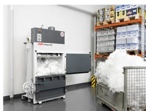
Zum Befüllen der Presse wird die obere Hälfte der Türe nach rechts aufgeschwenkt
