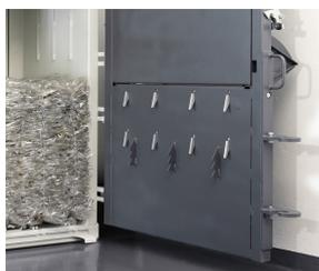
Spezielle Rückhaltekrallen optimieren die Verdichtung des Pressmaterials.
